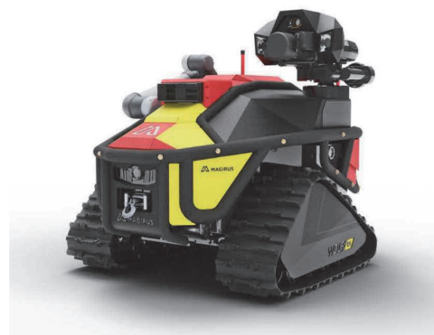
【無人走行放水ロボット】
